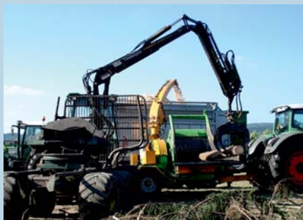
Bild oben: Holzvollernter und zugleich mobile Hackmaschine – der Harvester zerkleinert Restholz zu Hackschnitzeln.
